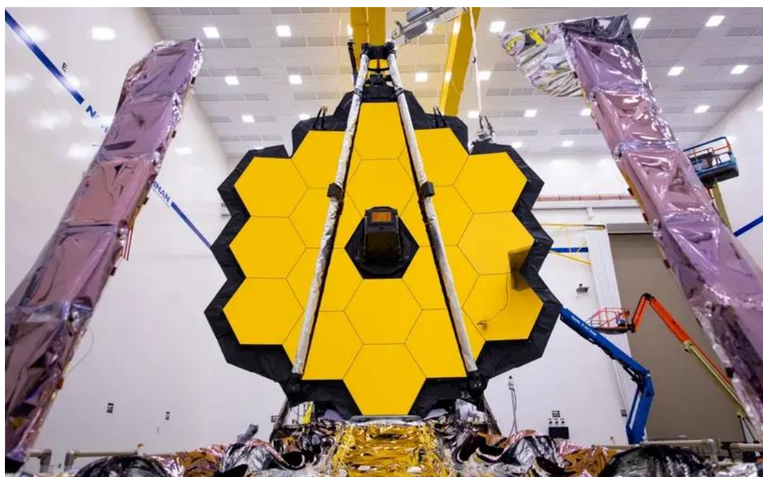
شکل ۸: ایده‌ی اولیه برای جیمز وب، که به عنوان تلسکوپ فضایی نسل بعد شناخته می‌شود. شامل یک آینه تقسیم بندی شده، طرح باز و یک آفتابگیر بزرگ قابل نصب است.
